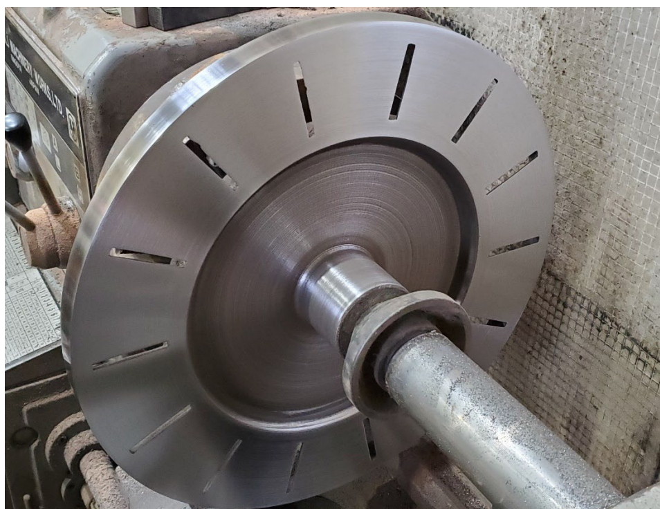
円盤修正研磨完了写真 (※円盤の表面全体の高低差を 20\mu 以内を精度基準としております)
